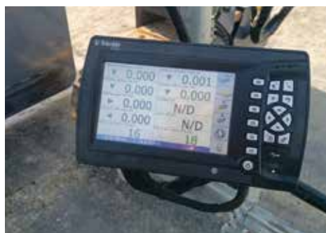
3. Sistema di Machine Control Trimble PCS900
